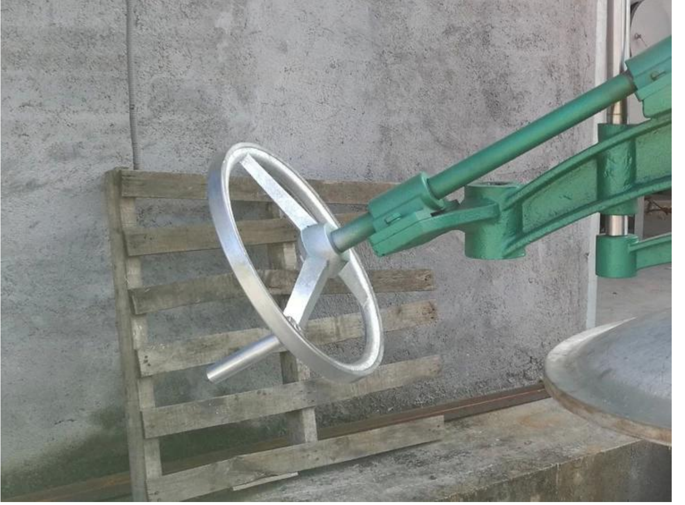
Böyüdülmüş əl çarxının dizaynı, barel qapağının daha sürətli qaldırılması.
