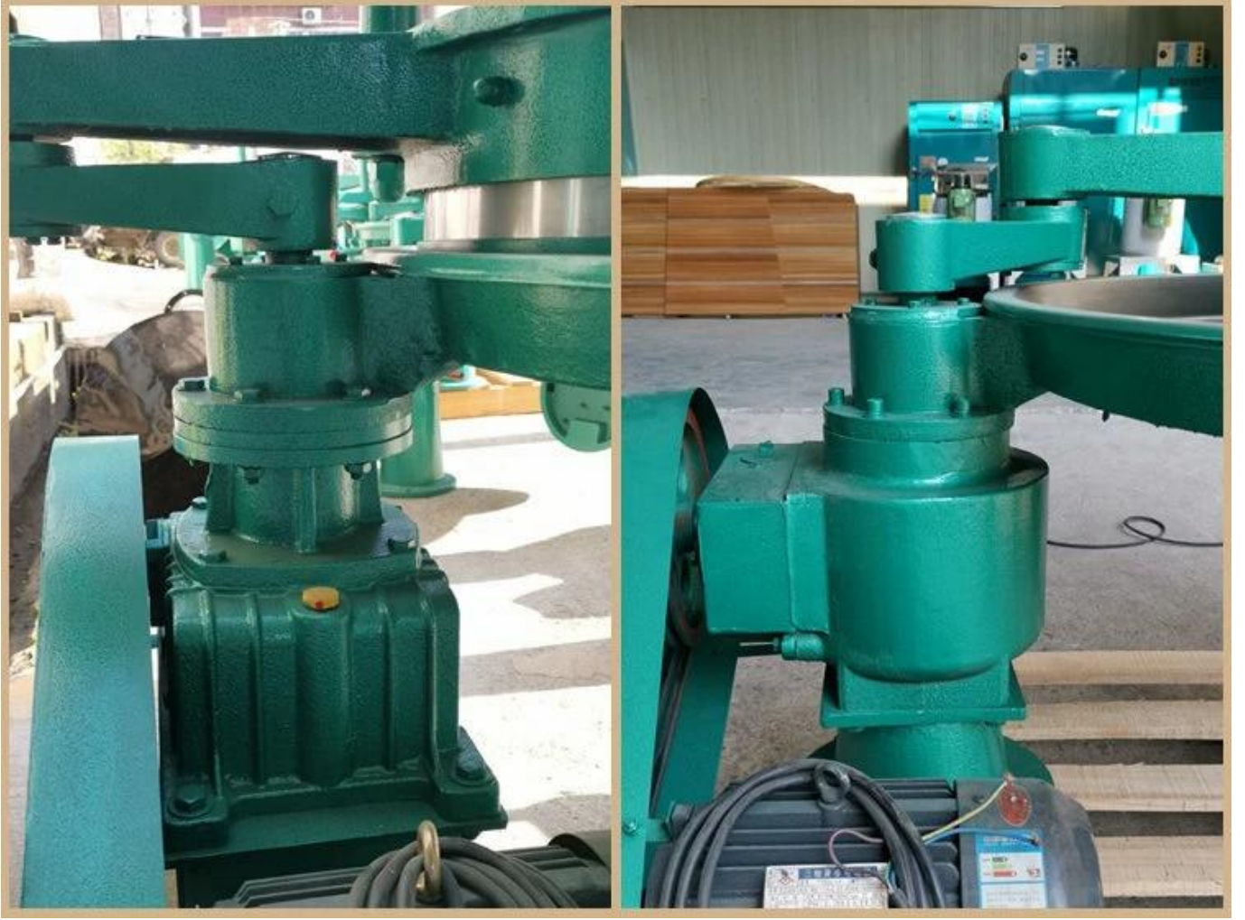
Turbin qurdları sürət qutusu dizayn, yavaşlama sabit və davamlıdır.
