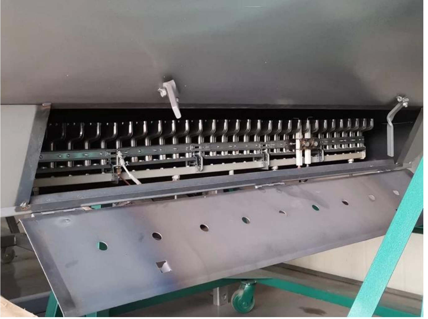
Çay fiksaj lüləsini əhatə edən, yanma sahəsini 100%-ə qədər əhatə edən T şəkilli yanma yanğınsöndürmə tağımı.
